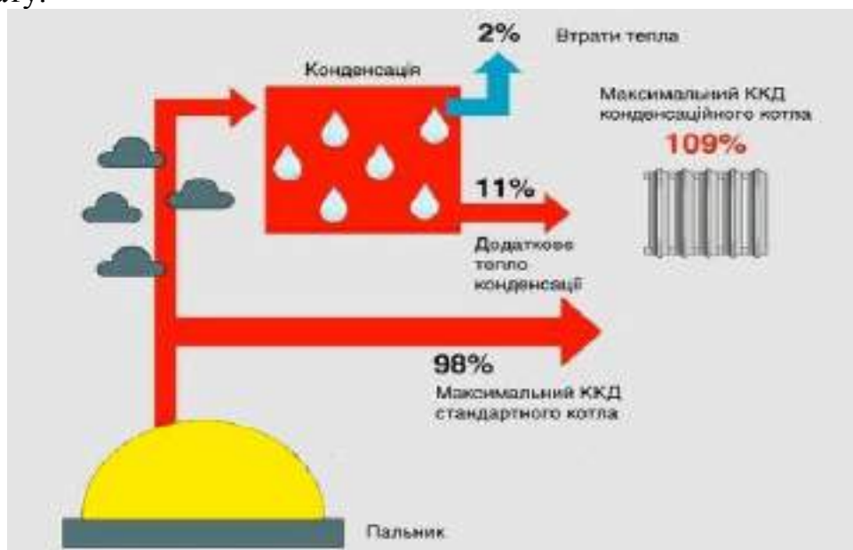
Рис 1. Порівняння принципу роботи конвекційного і конденсаційного котлів
